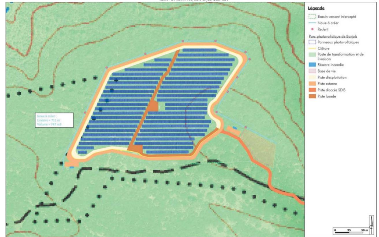
Illustration 45 : Représentation schématique de l'ouvrage de gestion des eaux pluviales
